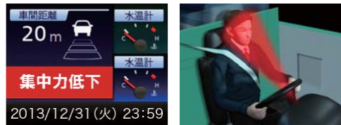
モニターカメラがドライバーの運転状態を確認
